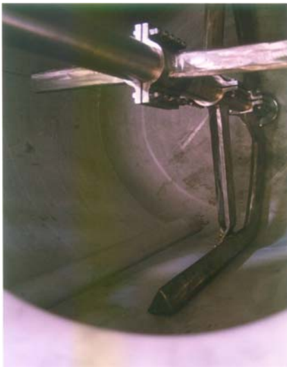
Particolari interno e lanterna agitatore per mescolatore da L 3500 Interior details and mixer's lantern for 3,500 L mixer
