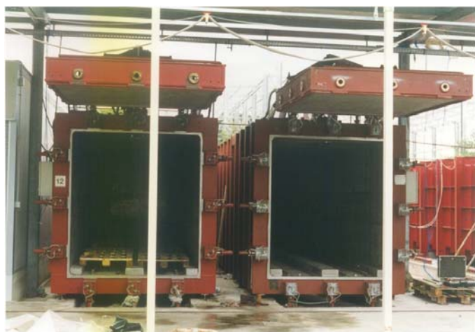
Vista frontale e gruppo di sicurezza autoclave da m 3 51 in AISI 304 Front view and safety group of m 3 51 autoclave in AISI 304
