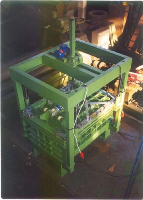
Viste superiore autoclave d'impregnazione vernici Upper view of autoclave for varnish impregnation
