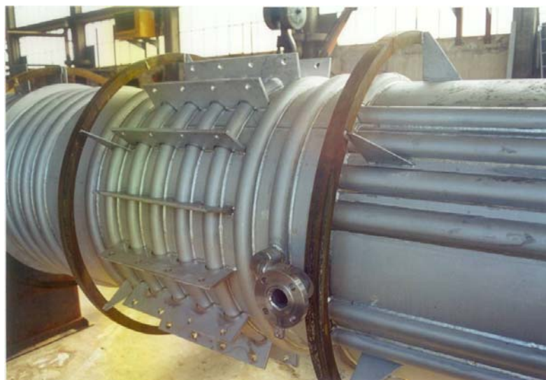
Colonna di frazionamento DN 800 in AISI 316 Fractioning column DN 800 in AISI 316
