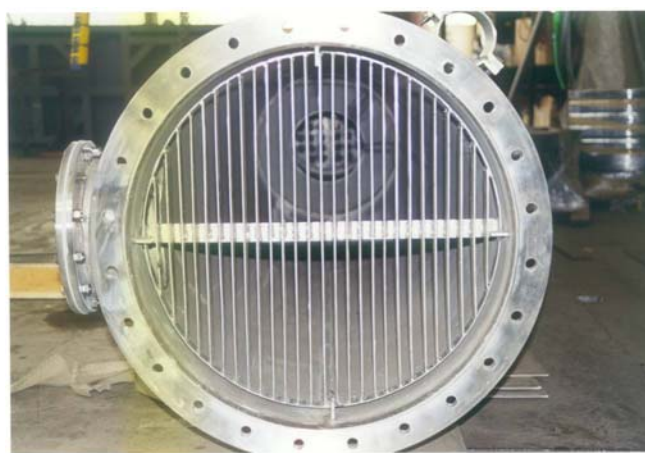
Particolari colonne di abbattimento ETO DN 600 in AISI 316 Details of reducing columns ETO DN 600 in AISI 316L
