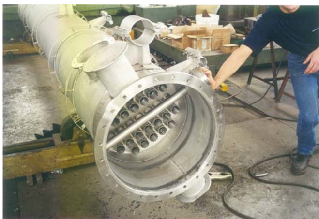
Particolari colonne di abbattimento ETO DN 600 in AISI 316 Details of reducing columns ETO DN 600 in AISI 316L
