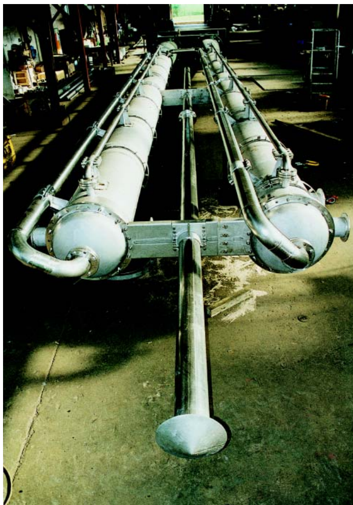
Colonne di abbattimento ETO DN 600 in AISI 316L Reducing columns ETO DN 600 in AISI 316L
