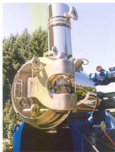
**Vista mescolatore / essiccatore DN 500 in AISI 316L e particolare scarico di fondo.**
