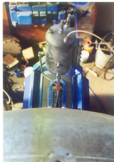
Particolari vista e barilotto di contropressione mescolatore / essiccatore da L 6000 in AISI 316 View and mixing/drying counter-pressure barrel of 6000 L, in AISI 316
