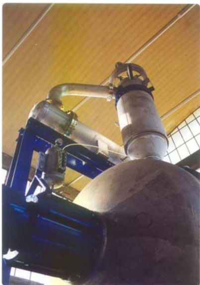
Particolari vista e barilotto di contropressione mescolatore / essiccatore da L 6000 in AISI 316 View and mixing/drying counter-pressure barrel of 6000 L, in AISI 316
