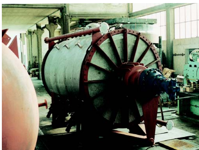
Mescolatore / essiccatore per polveri con albero rotante ed agitatori supplementari laterali da L 12000 in AISI 304
