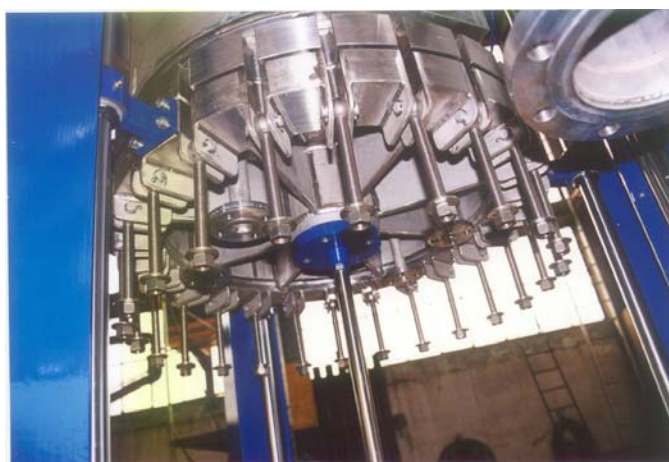
Vista dal basso e lanterna con movimentazione filtro pressa DN 600 Lower view and lantern view with handling of press filter DN 600
