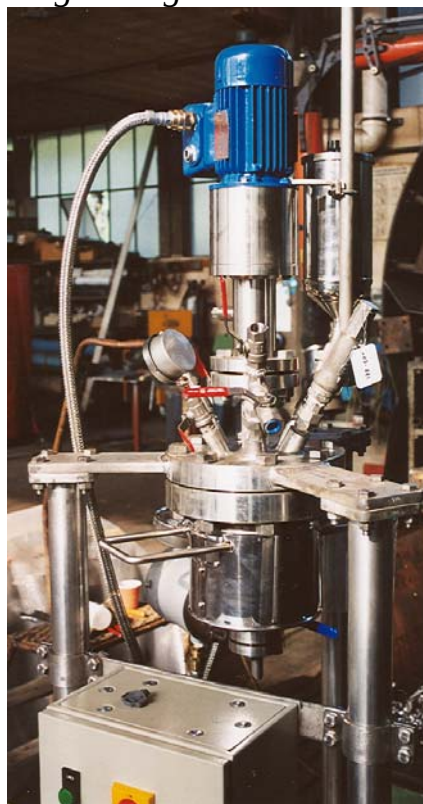
Idrogenatore da laboratorio DN 150 da L 4 in AISI 316 Laboratory hydro-generator DN 150, L 4, in AISI 316
