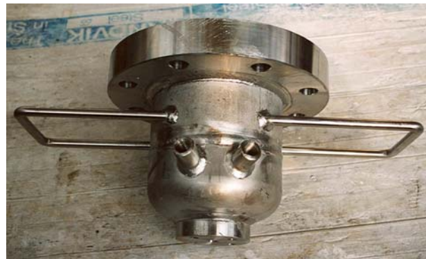
Scarico di fondo e sonda termometrica Detail of extractable main body
