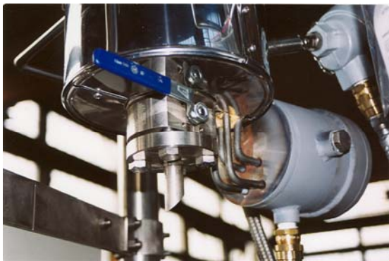
Particolare corpo principale estraibile Bottom exhaust and temperature probe
