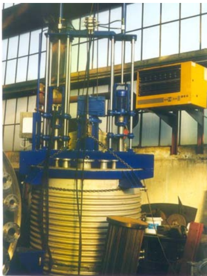
Mescolatore per paste da L 4500 in AISI 316 con agitatori laterali a corsa assiale Mixer for pulps, L 4500, in AISI 316 with lateral mixers of axial thrust
