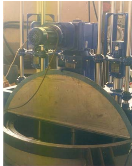
Mescolatore per paste da L 4500 in AISI 316 con agitatori laterali a corsa assiale Mixer for pulps, L 4500, in AISI 316 with lateral mixers of axial thrust
