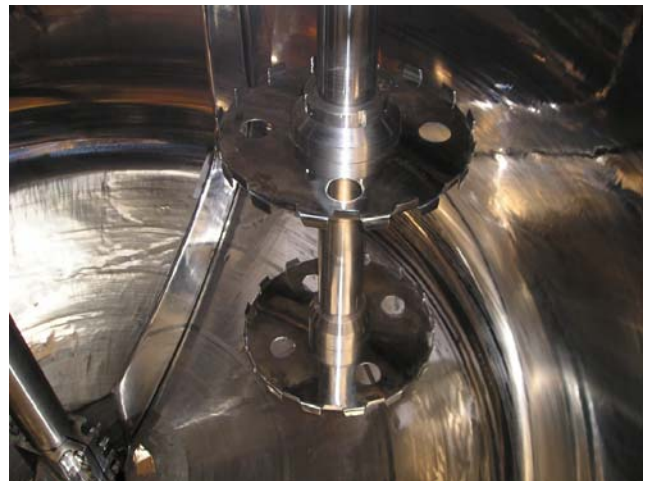
Agitatori e vista interna mescolatore per stucchi da L5000 in AISI 316 Mixers and internal view of mixer for plasters, L 5000, in AISI 316
