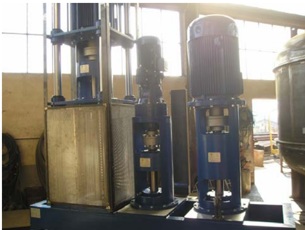
Agitatori e vista interna mescolatore per stucchi da L5000 in AISI 316 Mixers and internal view of mixer for plasters, L 5000, in AISI 316
