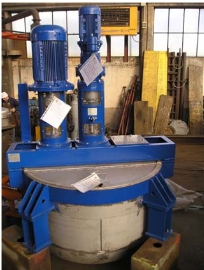
Mescolatore per stucchi da L 2000 in AISI 316 con agitatore centrale ad ancora ed uno laterale veloce. Potenza totale installata: 44.5 kW
