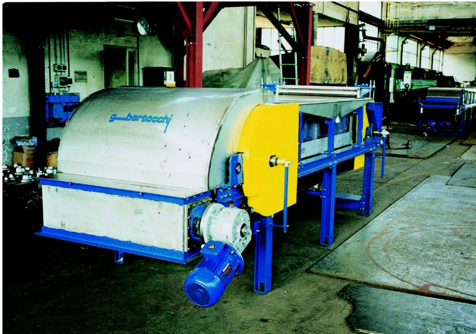
Nastro raffreddatore 1200x3000 con vasca a trascinamento e raschiatore con frantumatore Cooling belt 1200x3000 with dragging tank and scraper with breaker.
