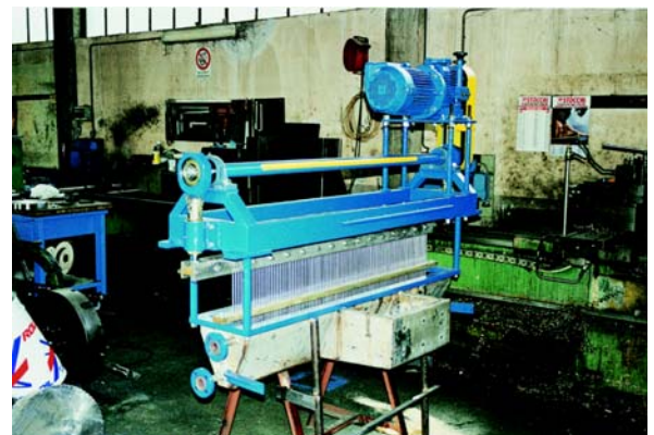
Gocciolatoio pastigliatore a 90 aghi con vasca incamiciata per riscaldamento vapore in AISI 316 90 shaft dropper with sheathed tank for steam heating, in AISI 316
