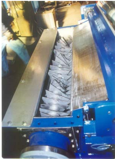
Vista frantumatore e particolare nastro raffreddatore 1200x3000 Breaker view and detail of cooling belt 1200x3000
