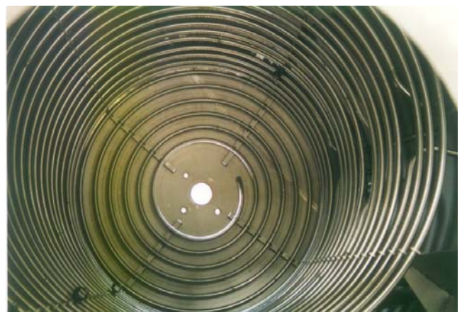
Reattore da L 25000 con agitatore, semitubo esterno e serpentino interno in AVESTA 904 L collaudato ISPESL
