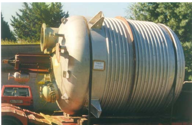
Reattore da L 25000 con agitatore, semitubo esterno e serpentino interno in AVESTA 904 L collaudato ISPESL
