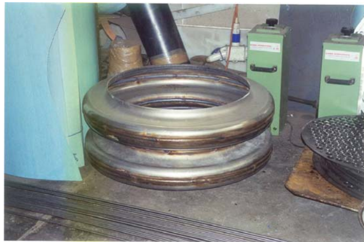
Particolari piastra tubiera e giunto di dilatazione a doppia onda Details of tube plate and dual-band, expansion joint.
