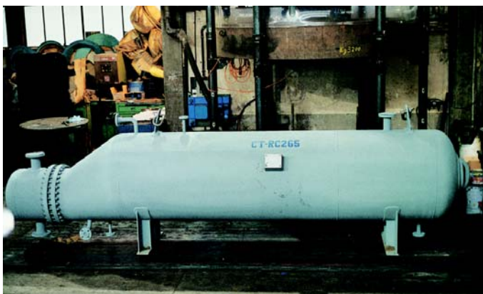
Generatore di vapore in acciaio al carbonio a fascio tubiero da 82 m 2 - 750000 kcal/h Steam generator in carbon steel with tube bundle of 82 m 2 - 750000 kcal/h
