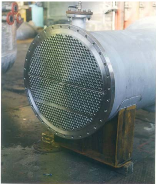
Particolari piastra tubiera e giunto di dilatazione a doppia onda Details of tube plate and dual-band, expansion joint.
