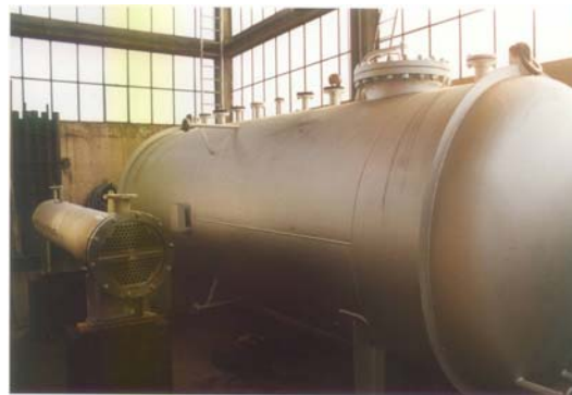
Serbatoio di blow-down in acciaio al carbonio da m 3 10 Blow-down vessel in carbon steel, of m 3 10
