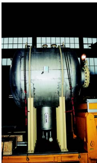
Serbatoio separatore da L 10000 in AVESTA 904L costruito secondo ASME VIII div.1 L 10000 separator vessel in AVESTA 904L built according to ASME VIII div.1
