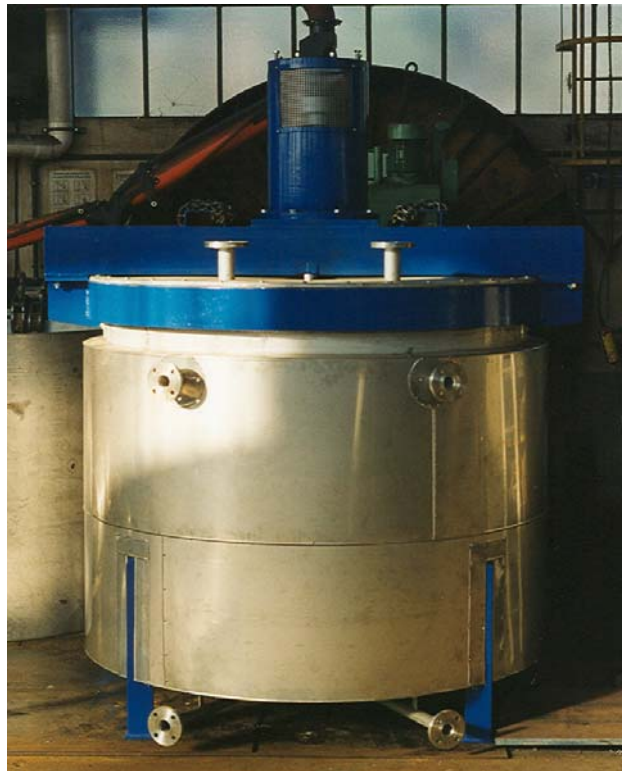
Serbatoio Mescolatore da L 3000 - 3000 L Mixer vessel
