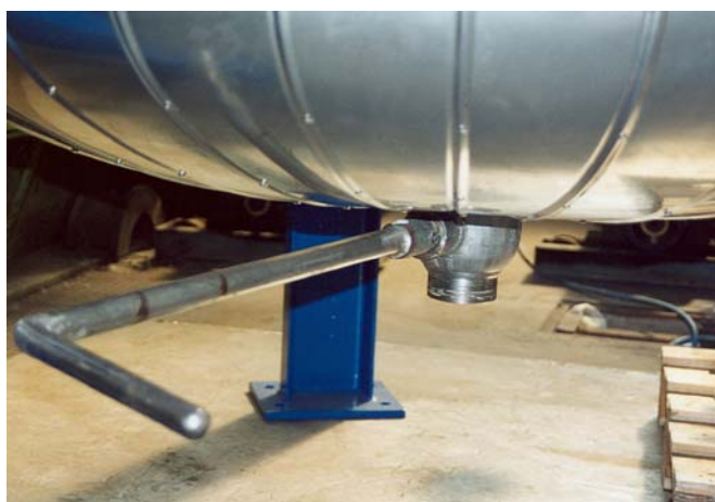
Scarico di fondo - Base discharge
